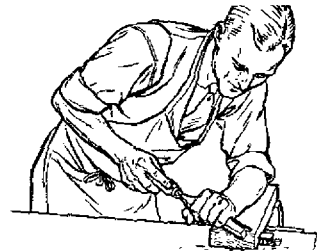
(d) Paring Chisel used for Horizontal Paring.
