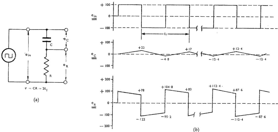
FIG. 4. LONG TIME CONSTANT CIRCUIT.
