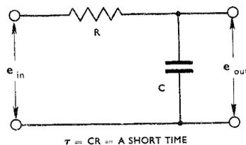
FIG. 15. HIGH FREQUENCY LOSS CIRCUIT.
