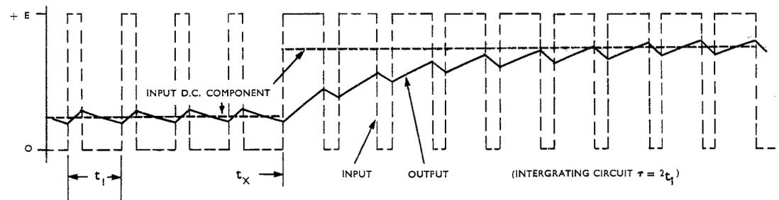
FIG. 39. INTEGRATING CIRCUITS.
