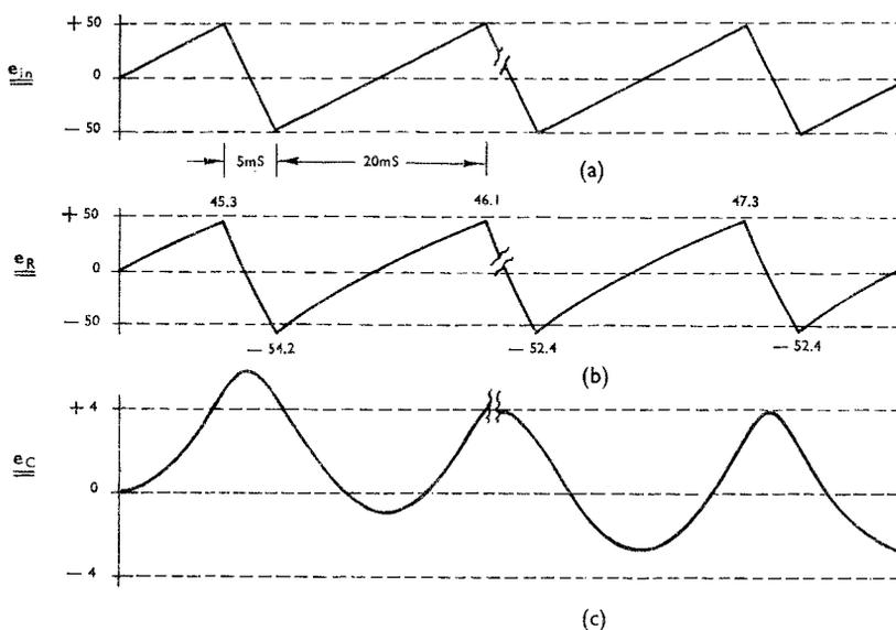
FIG. 9. SAWTOOTH WAVES IN LONG TIME CONSTANT R-C CIRCUIT.
