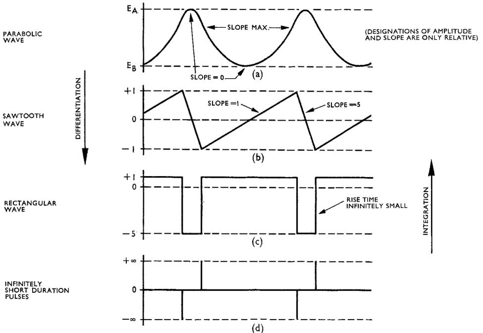
FIG. 34. INTEGRATION OF WAVEFORMS.
