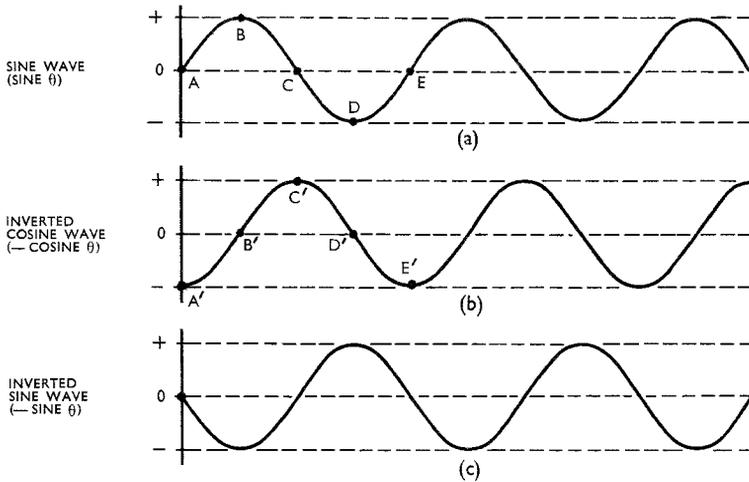
FIG. 35. INTEGRATION OF A SINE WAVE.
